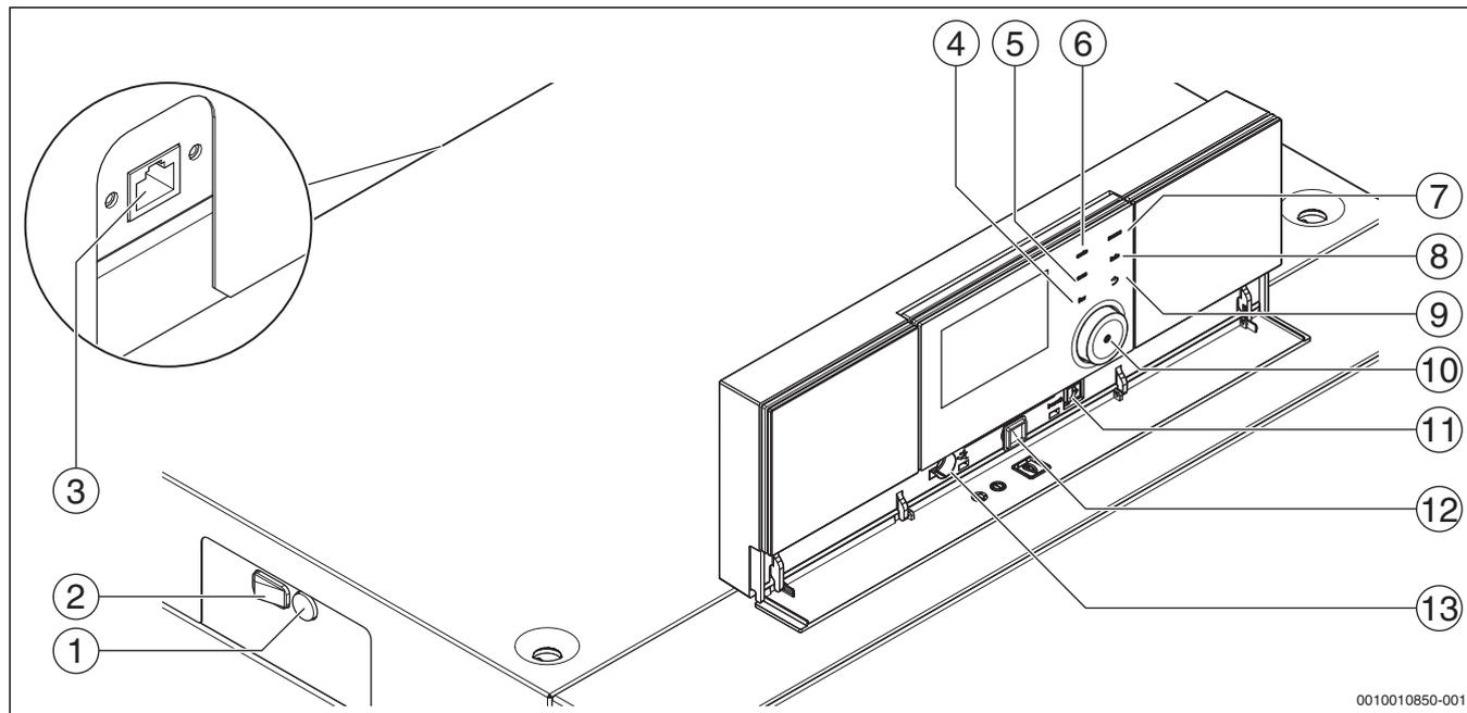
Bild 2 Bedieneinheit (Basiscontroller mit RC310) – Bedienelemente
