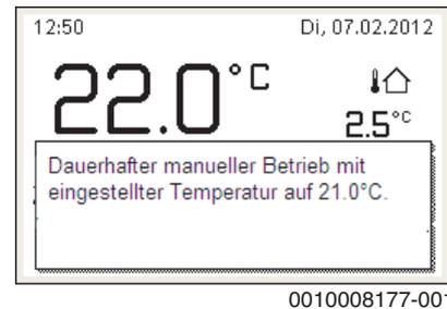
Ein Pop-up-Fenster wird angezeigt und die Raumtemperatur wird dauerhaft auf den eingestellten Wert geregelt.
