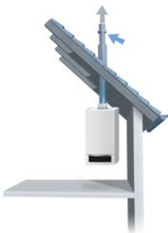
Variante type ventouse avec conduite d'évacuation des fumées pour une installation sous le toit.
