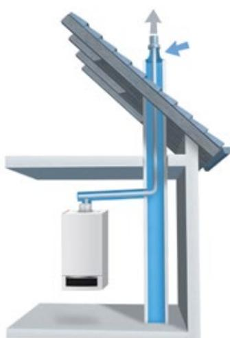
Variante type ventouse avec conduite d'évacuation des fumées en matière synthétique à l'intérieur de la cheminée (adaptée à l'aspiration d'air par la section annulaire du conduit)
