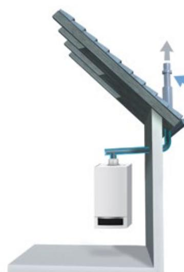
Variante type ventouse avec système d'évacuation des fumées en matière plastique tube dans tube (façade extérieure)
