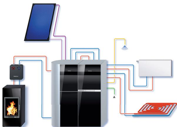
La classification énergétique indiquée est obtenue avec un système Buderus comprenant: Chaudière Logamax plus GBH192iT150S, tampon PNR400, régulation Logamatic RC300 plus, 4 panneaux solaire Logasol SKT 1.0. La classification énergétique peut encore différer en fonction des composants de l'installation ou de la puissance de la chaudière.
