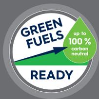
Mit dem „Green Fuels Ready“-Produktlabel kennzeichnen Hersteller Produkte wie z. B. Öl-Brennwertkessel, Tanks und andere Komponenten einer Ölanlage, die für treibhausgasneutrale flüssige Brennstoffe (=„Green Fuels“) und beliebige Mischungen mit fossilen flüssigen Brennstoffen geeignet sind. Konkrete Beispiele dafür sind rein paraffinische Heizöle (z. B. HVO) oder auch Mischungen von mineralischen Heizölen mit Biokomponenten (z. B. FAME).
