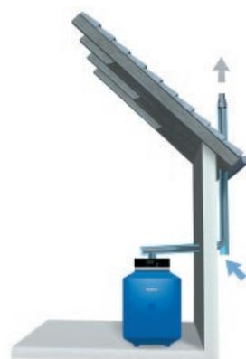
Raumluftunabhängige Aufstellvariante mit Rohr-in-Rohr-Kunststoff-Abgassystem entlang der Außenfassade.
