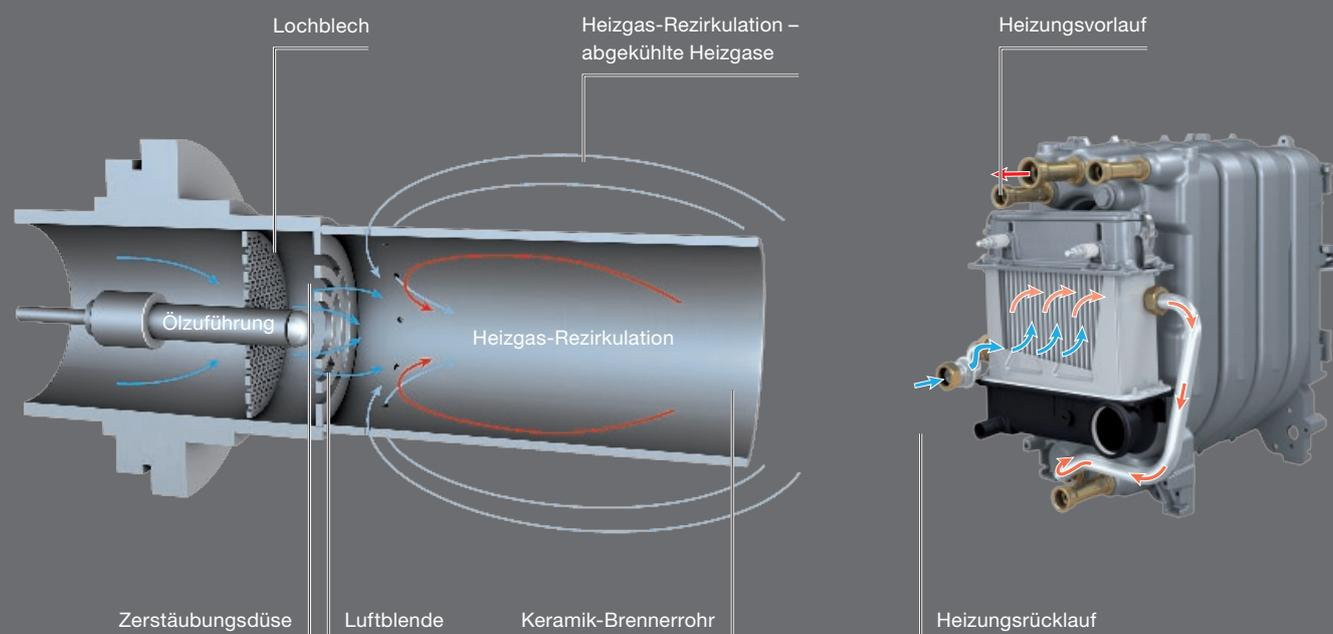
Mit raffinierter Technik garantiert der Blaubrenner Logatop BE<sup>1</sup> eine besonders effiziente und praktisch rußfreie Verbrennung. Ein Unterdruck an der Öl-Austrittsdüse saugt die Heizgase zurück. So verdampfen die Öltröpfchen, bevor sie verbrennen.
