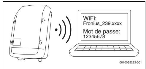
Fig. 12 Connecter l'ordinateur/smartphone au Point d'accès au réseau local sans fil
