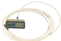
Thermomètre numérique (DTA)               | <ul style="list-style-type: none"> <li>■ Pour ballon (L / LT) ≤ 300 l</li> <li>■ Pour ballons à partir de 500 l, support supplémentaire nécessaire pour thermomètre</li> <li>■ À intégrer dans le panneau avant ou le support de thermomètre</li> <li>■ Longueur du câble de sonde 3 m et batterie</li> </ul>                                                 | 7747201004 | 80,—  | SW09 |
