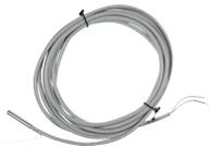
Sonde Ø 9,7 mm avec accessoire          | <ul style="list-style-type: none"> <li>■ Sonde Ø 9,7 mm (NTC10K, longueur de câble 3 m) pour les systèmes de régulation Logamatic EMS plus, 4000 et 5000</li> <li>■ Avec pâte thermoconductrice et accessoires pour le montage en tant que sonde de contact sur tuyau</li> <li>■ Fiche de raccordement non fournie (comprise dans le système de régulation Logamatic EMS plus et 5000)</li> </ul>
