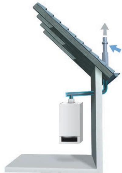
Variante type ventouse avec système d'évacuation des fumées en matière plastique tube dans tube (façade extérieure)
