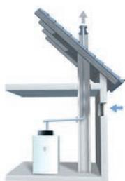
Variante au sol type cheminée avec tuyau des fumées dans la cheminée (air neuf apporté par une ouverture d'aération).
