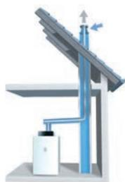
Variante au sol type cheminée avec système air-fumées concentrique en plastique dans le conduit de cheminée ou la gaine.
