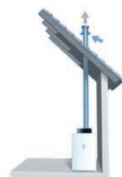
Variante au sol type cheminée avec système air-fumées concentrique en plastique, avec traversée de toit.
