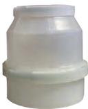
Anschlussatz Überdruckklappe                  | <ul style="list-style-type: none"> <li>■ Rückströmsicherung für Logamax plus GB272-50 bis 100 kW bei Einsatz fremder Abgassysteme</li> <li>■ Max. Gegendruck auf der Rückschlagklappe, wenn 1 Gerät aus ist = 50 Pa</li> <li>■ Die untere Geräteleistung muss nach Montageanleitung angehoben werden</li> <li>■ Strömungswiderstand bei Leistung: 100 kW - ca. 80 Pa, 85 kW - ca. 55 Pa, 70 kW - ca. 30 Pa, 50 kW - ca. 25 Pa</li> </ul>
