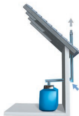
Installation type ventouse avec conduit d'évacuation des fumées tube dans tube le long de la façade extérieure.
