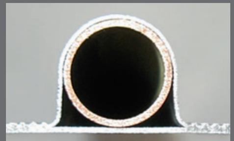
Durch die Omega-Ultraschall-Verschweißung vergrößert sich die Kontaktfläche für den Wärmeübergang.
