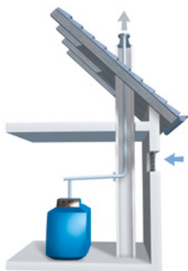
Raumluftabhängige Aufstellvariante mit eingezogenem Abgasrohr im Schornstein.
