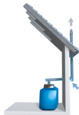
Raumluftunabhängige Aufstellvariante mit Rohr-in-Rohr-Kunststoff-Abgassystem entlang der Außenfassade.
