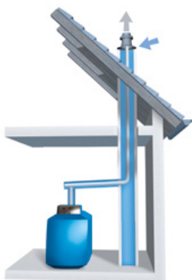
Raumluftunabhängige Aufstellvariante mit eingezogener Kunststoff-Abgasleitung im Schornstein.
