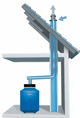
Variante type ventouse avec tuyau d'évacuation des fumées synthétique dans la cheminée.
